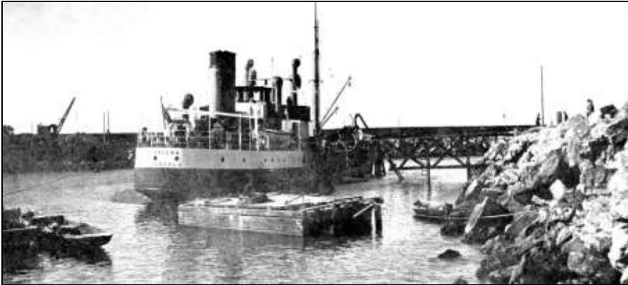
figure 7 : Premier bateau citerne du Maroc ; acheté neuf, le navire FEDHALA de la Compagnie Marocaine de Transports Maritimes, en opération de déchargement (1926) au port de Fedala (Mohammedia) ; construit aux Chantiers Navals Français (Blainville) ; longueur 49 m, jauge brute 522 tx ; moteur 600 cv ; (photo : Helderline Shell Tanker ).
