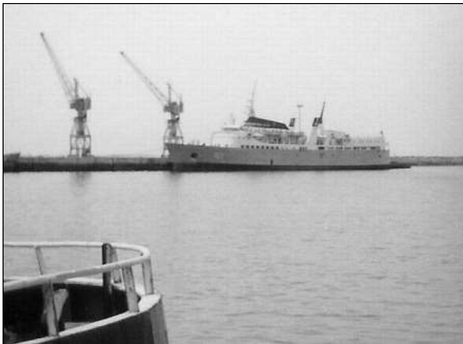
figure 17 : Le navire de passagers ARRARIQ (1987-1993) ; jauge brute 2 774 tx, longueur 93,2 m, largeur 16,4 m, tirant d'eau 5,36 m, port en lourd 744 t, puissance 8 000 cv, vitesse 15,5 nds ; construit en Hollande (Hardinxveld) en 1964 ; photo : Bert Carlsson.
