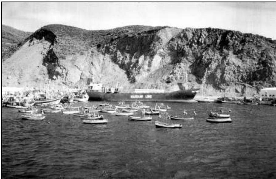
figure 14 : Le navire cargo ASMAA (1977–1989) ; 499 tx de jauge brute, longueur 76,6 m ; construit au Danemark (Frederikshavn) en 1972 ; ici à M'Diq (Maroc) en 1985 entrain de livrer des matériaux nécessaires à la construction d'infrastructures portuaires ; photo : Cdt. Dahmane.
