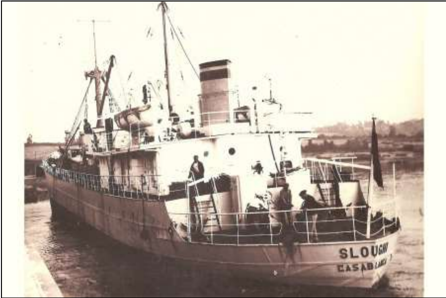
figure 6 : Le navire citerne SLOUGHY (1948-1978) ; 649 tx de jauge brute, longueur 53,7 m ; au port de Tréguier en 1948 ; photo : Yvon Perchoc.
