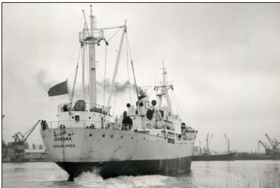
figure 8 : Le navire cargo ZAGORA (1956-1973) ; 1 437 tx de jauge brute, longueur 79,2 m ; construit en France (La Seyne Sur Mer) en 1950 ; photo : Yvon Perchoc.
