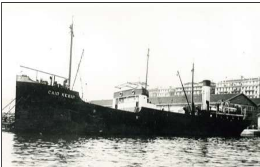
figure 4 : Le navire vapeur CAID KEBIR (1930-1934) \approx 756 tx de jauge brute, longueur 55,20 m ; construit en Hollande (Slikerveer) en 1917 ; photo : Yvon Perchoc.
