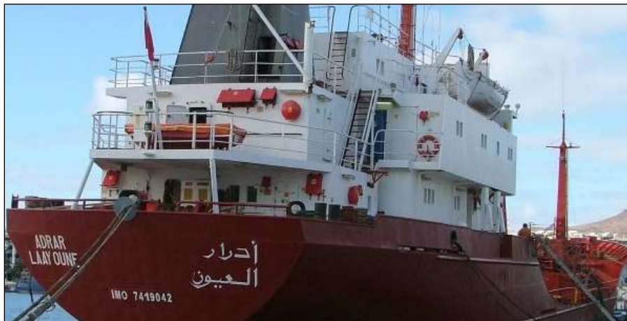
Figure : Le navire citerne marocain ADRAR en flotte de 2002 à 2009 ; inscrit à Laayoune ; l'identifiant IMO7419042 figure sur son tableau arrière ; il se compose de sept chiffres, le dernier représente le code d'autocontrôle.
